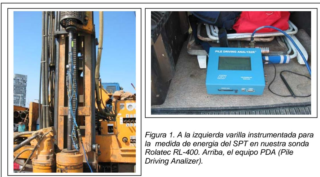
Figura 1. A la izquierda varilla instrumentada para la medida de energía del SPT en nuestra sonda Rolatec RL-400. Arriba, el equipo PDA (Pile Driving Analyzer).
